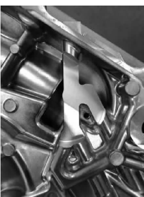
图 5 剖切后产品无缩孔
